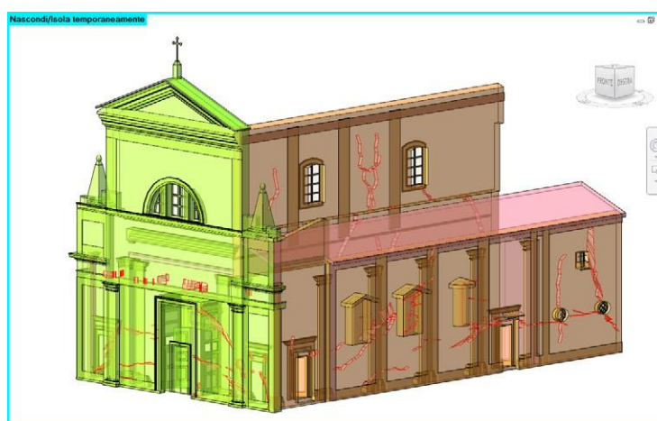
Fig. 81 - Macroelementi isolati come ausilio all'analisi delle lesioni
