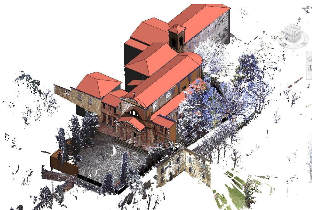
Fig. 50 - Confronto tra la nuvola di punti ed il modello tridimensionale
