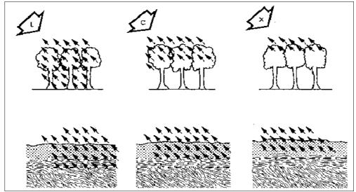
Figura 24: Capacità di penetrazione dell'onda elettromagnetica negli alberi (sopra) e nel terreno (sotto) per le bande L, C ed X. (Fonte: [17])
