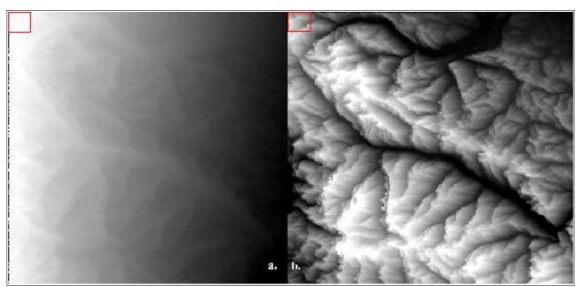
Figura 51: Ghiacciaio Aletsch: DEM in geometria slant range espresso in termini di: a. fase (\_sint); b. quota ( srdem).
