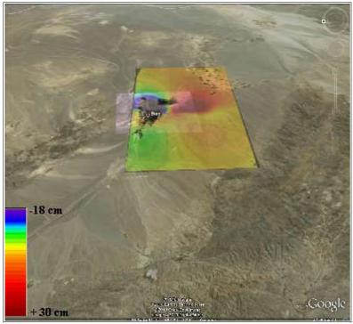
Figura 65: Sovrapposizione della mappa di spostamento (in falsa scala di colori) ad un'immagine fotografica dell'area d'indagine ottenuta attraverso Google Earth<sup>®</sup>. L'esportazione dell'immagine in formato .kml compatibile con la piattaforma Google Earth<sup>®</sup> è stata effettuata per mezzo del tool SPEAR di Envi<sup>®</sup>.
