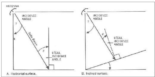
Figura 18: Angolo di incidenza ed angolo di incidenza locale. (Fonte: [17])
