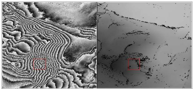
Figura 29: Figura 3: Confronto tra un' immagine (particolare) interferometrica spianata (a sinistra) e srotolata (a destra).
