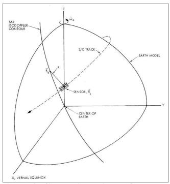
Figura 52: Sistema di coordinate ECR per la georeferenziazione del pixel: si nota l'intersezione tra il raggio di slant range e l'ellissoide, che avviene sulla linea di isodoppler. (Fonte: [41])
