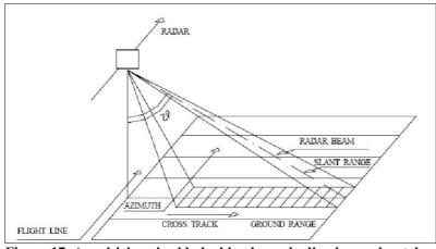
Figura 17: Acquisizione in side-looking lungo la direzione azimutale. (Fonte: [17])
