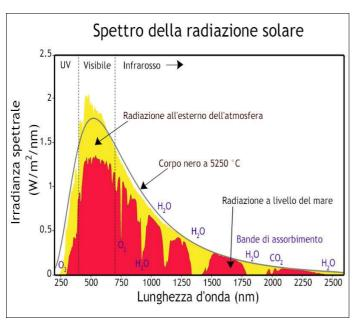
Figura 9: Irradianza di un corpo nero alla stessa temperatura del Sole confrontata con l'irradianza solare dopo aver attraversato l'atmosfera (Fonte: [14])
