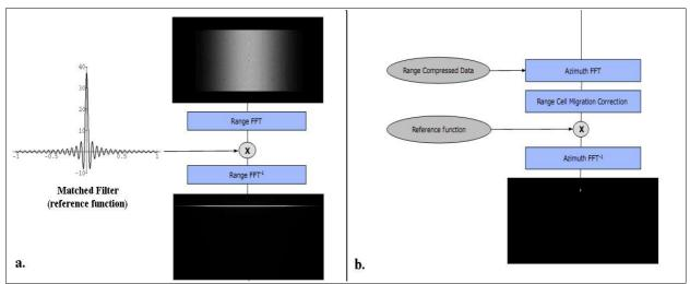
Figura 42: a. Funzione Range Compression. b. Funzione Azimuth Compression. (Fonte: [19])
