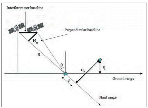
Figura 27: Parametri geometrici del sistema InSAR. (Fonte: [20])
