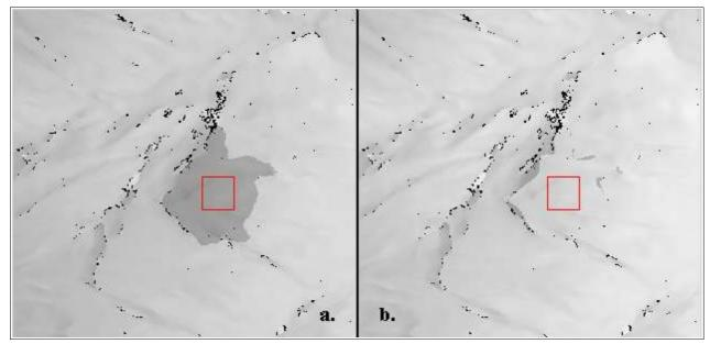
Figura 61: Phase Editing, ghiacciaio dell'Aletsch immagine 23/24 Novembre 1995: a. isola di fase contenente un errore di srotolamento b. isola di fase editata, con correzione del salto di fase.
