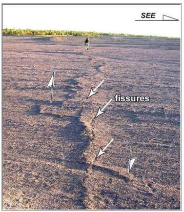
Figura 1: Fessurazioni del terreno a seguito del terremoto di Bam, nell'Iran meridionale. (Fonte: [5])
