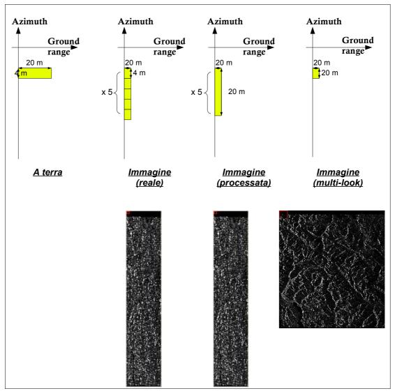
Figura 46: Step fondamentali del processo di multi-look, con esempio l'immagine del ghiacciaio Aletsch del 19 Ottobre 1995
