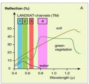
Figura 10: Firma spettrale di alcune classi di copertura del suolo e bande coperte dai primi quattro canali del sensore Landsat TM (Fonte: [15])
