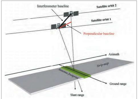
Figura 26: Geometria di acquisizione di un sistema satellitare SAR interferometrico. (Fonte: [20])
