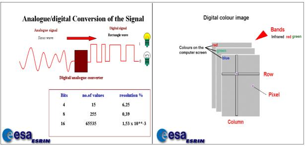
Figura 11: Digitalizzazione del segnale analogico e trasposizione dello stesso in matrici corrispondenti alle bande di colore RGB (Fonte: [15])
