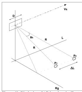
Figura 40: Risoluzione SAR in azimuth. (Fonte: [35])
