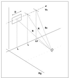
Figura 41: Percorso del sensore SAR intorno al target. (Fonte: [35])
