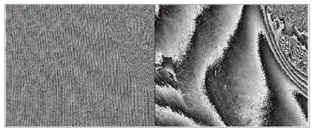
Figura 28: Confronto tra un particolare d'immagine interferometrica semplice (a sinistra) e spianata (a destra).
