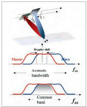
Figura 48: Spostamento dello spettro di frequenza in direzione azimuth. (Fonte: [19])
