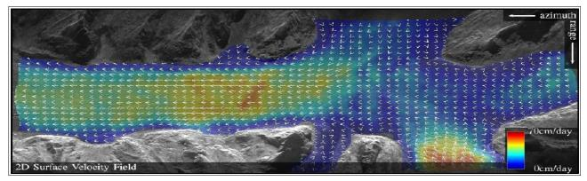
Figura 72: Mappa di SVF ottenuta tramite elaborazione InSAR di immagini radar in banda L in Ottobre 2006. (Fonte: [50])
