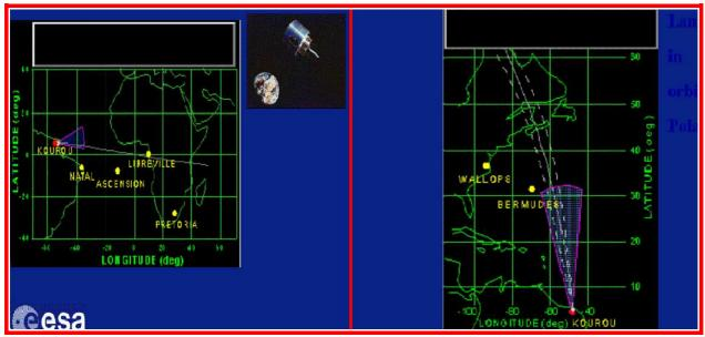
Figura 12: Confronto tra le traiettorie di un satellite geostazionario (a sinistra, durante la fase di posizionamento) e polare (a destra). Fonte: [15])
