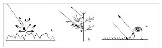
Figura 25: Meccanismi di diffusione dei bersagli a terra: a. Diffusione superficiale b. Diffusione di volume c. Diffusione a doppio rimbalzo. (Fonte: [19])
