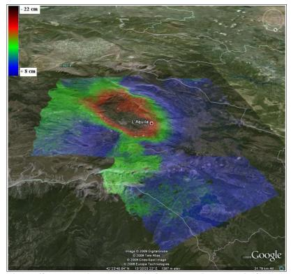
Figura 68: Mappa di spostamento in falso colore importata in Google Earth® tramite i tool SPEAR
