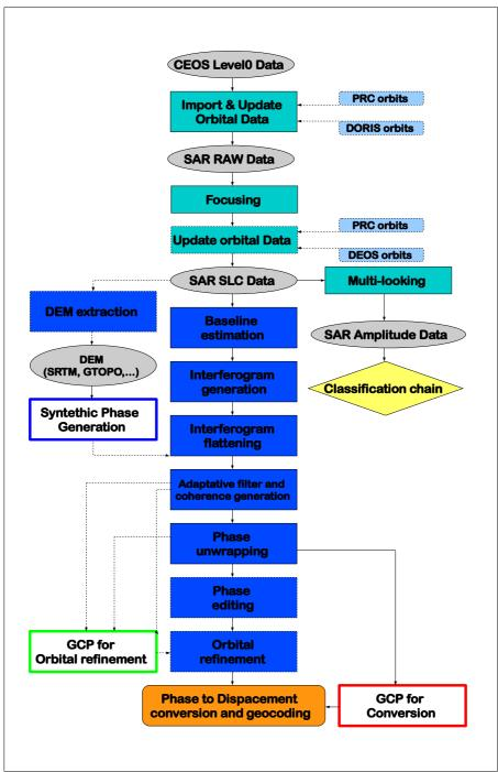
Figura 38: Diagramma di flusso rappresentativo della catena interferometrica di generazione di una mappa di spostamento all'interno di Sarscape<sup>®</sup>.
