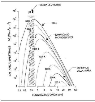
Figura 8: Andamento dell'exitanza spettrale al variare della temperatura (Fonte: [13])
