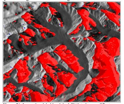
Figura 56: Immagine del ghiacciaio dell'Aletsch geocodificata, con una maschera sulle zone di shadow.
