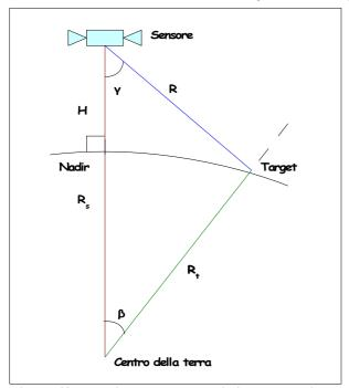
Figura 43: Relazione tra angolo di vista e vettori di posizione del sensore e del target. (Fonte: [36])
