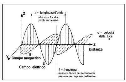
Figura 5: Andamento dei campi di forza nell'onda elettromagnetica. (Fonte: [11])
