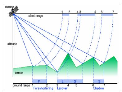
Figura 23: Distorsioni geometriche dovute alla topografia. (Fonte: [17])
