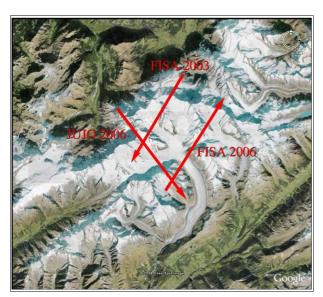
Figura 71: Configurazione delle campagne 2003 e 2006. Da notare che tutti i sensori guardano verso sinistra rispetto alla direzione di volo. (Fonte: [49])
