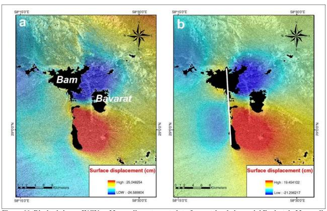
Figura 66: Risultati ricerca INGV: a. Mappa di spostamento interferometrica da immagini Envisat; b. Mappa di spostamento GIS ricavata da un interferogramma sintetico. (Fonte: [28])
