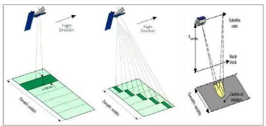
Figura 22: Metodi di acquisizione satellitare, da sinistra a destra: Stripmap Mode, ScanSAR Mode e Spotlight Mode. (Fonte: [19])
