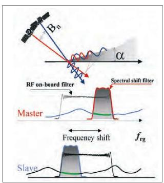
Figura 47: Sfasamento dello spettro di frequenza in direzione range. (Fonte: [19])
