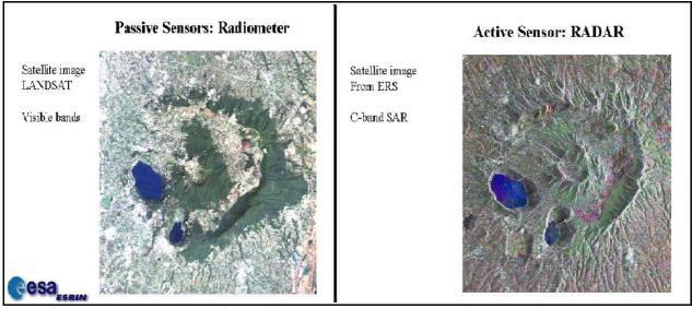
Figura 14: Immagine ottenuta da un'acquisizione con sensore passivo (a sinistra) ed attivo (a destra). (Fonte: [5])
