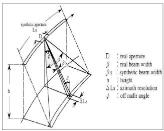
Figura 19: Geometria di acquisizione del SAR in azimut. (Fonte: [19])
