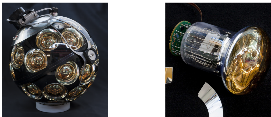
Figura 2.1: A sinistra l'immagine di un DOM. Si tratta di una sfera di vetro dal diametro di 44 cm, contenente 31 PMTs. A destra è presente un singolo PMT necessario alla rivelazione di luce Čerenkov. Crediti: KM3NeT, https://www.km3net.org/ .
