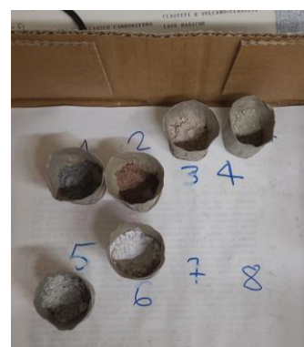
Figura 49 – In figura si possono osservare i crogioli con all'interno le polveri come si presentano post esposizione al calore del forno.
