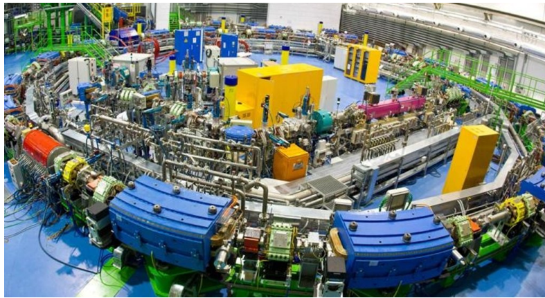
Figura 1.23: Il sincrotrone del CNAO di Pavia, utilizzato per l'accelerazione di protoni e ioni carbonio [29].
