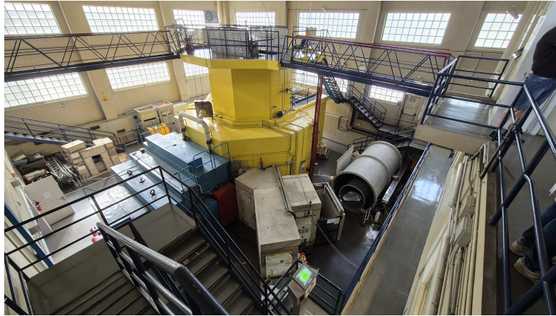
Figura 1.13: Reattore TRIGA Mark II utilizzato presso l'Università di Pavia per le prime applicazioni italiane della BNCT [25].
