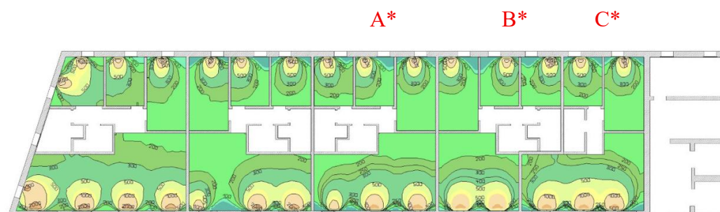
Restituzione grafica attraverso il software DIALux dell'edificio sud senza il ballatoio.
