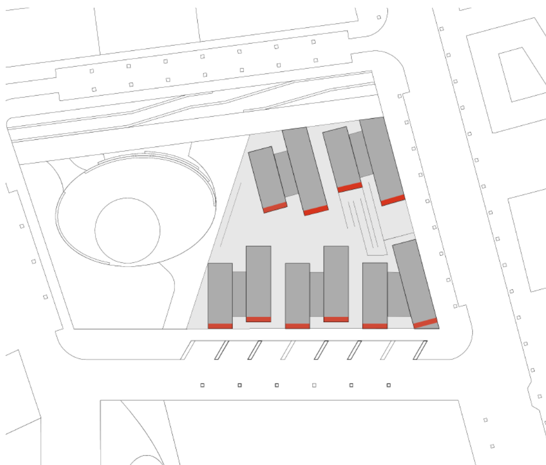
Localizzazione e rotazione verso sud delle logge (Fonte: Autori)
