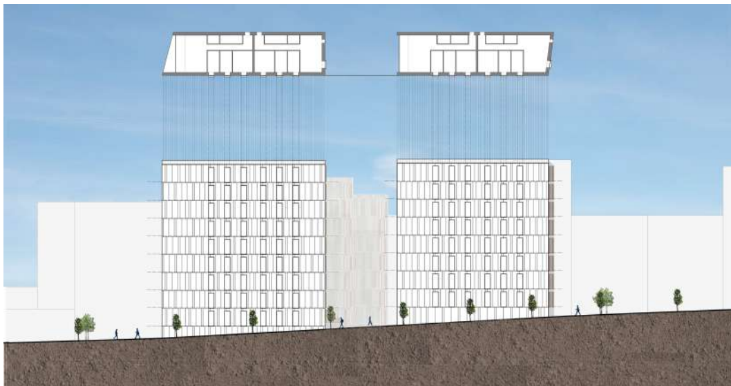
Prospetto est del lotto con individuazione della griglia modulare (Fonte: Autori)
