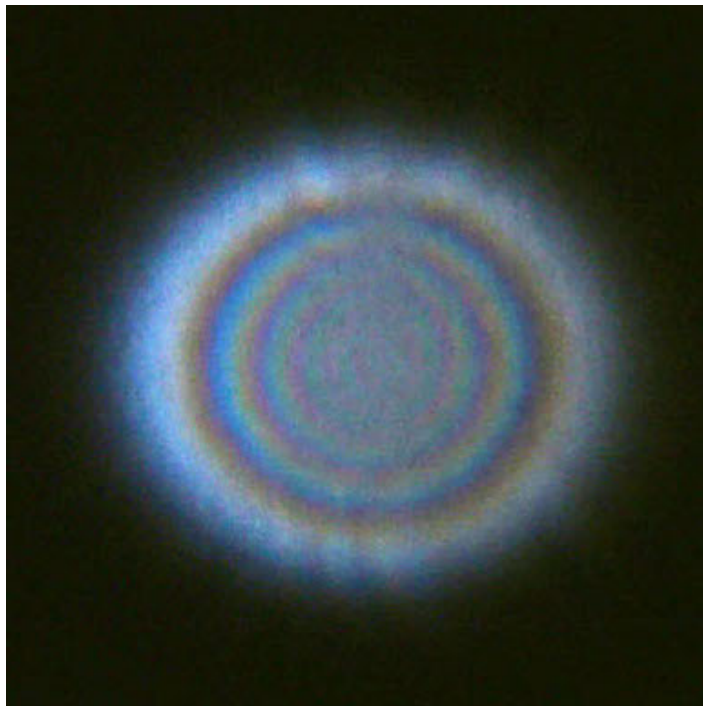
Figura 4.20: Figura di diffrazione ottenuta utilizzando un'apertura circolare preformata, di produzione industriale e di diametro pari a circa 4 mm. Sono ben visibili anelli concentrici luminosi, riconducibili alla diffrazione di Fresnel da apertura circolare. L'immagine è riportata senza modifiche.
