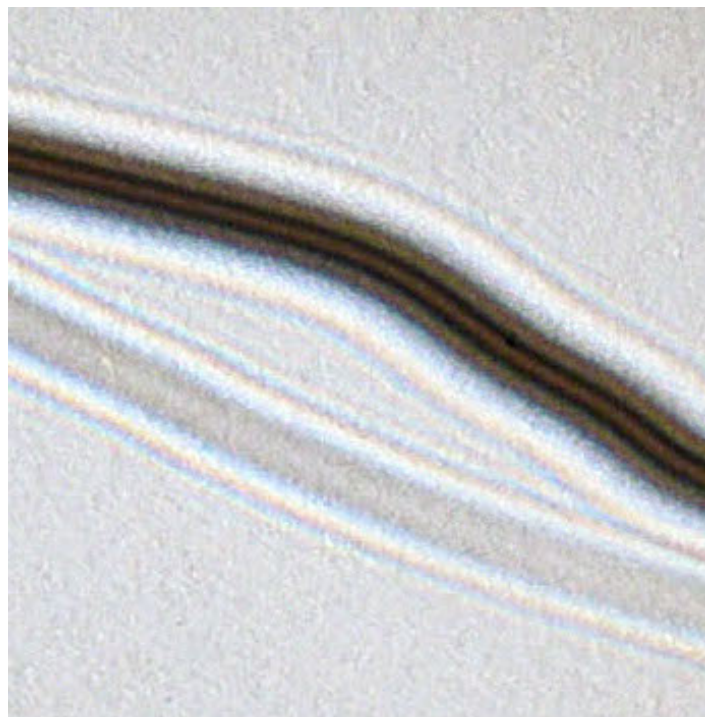
Figura 4.10: Confronto tra ombre ottenute con un capello (in basso) e con un filo di ferro (in alto) di diametro pari a 0,9 mm, utilizzando luce solare. La distanza tra il foro e l'ostacolo è di circa 160 cm, mentre quella tra l'ostacolo e lo schermo è di circa 130 cm. L'immagine è riportata senza modifiche.
