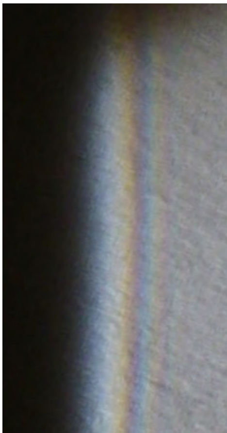
Figura 4.3: Frange di diffrazione prodotte dal bordo rettilineo di un ostacolo opaco, osservate utilizzando luce solare. La distanza tra il foro e l'ostacolo è di circa 160 cm, mentre quella tra l'ostacolo e lo schermo è di circa 130 cm.
