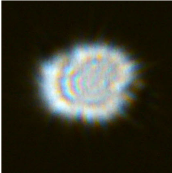
Figura 4.19: Figura ottenuta utilizzando un foro realizzato manualmente su cartoncino: la macchia luminosa appare poco definita. L'immagine è riportata senza modifiche.
