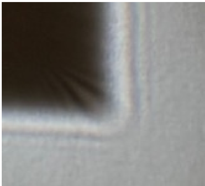
Figura 4.16: Frange interne osservate in prossimità dello spigolo di un oggetto opaco. L'andamento delle bande luminose richiama la descrizione di Grimaldi, che paragona queste frange alle nappe di un galero. L'esperimento è stato realizzato utilizzando luce solare. L'immagine è riportata senza modifiche.
