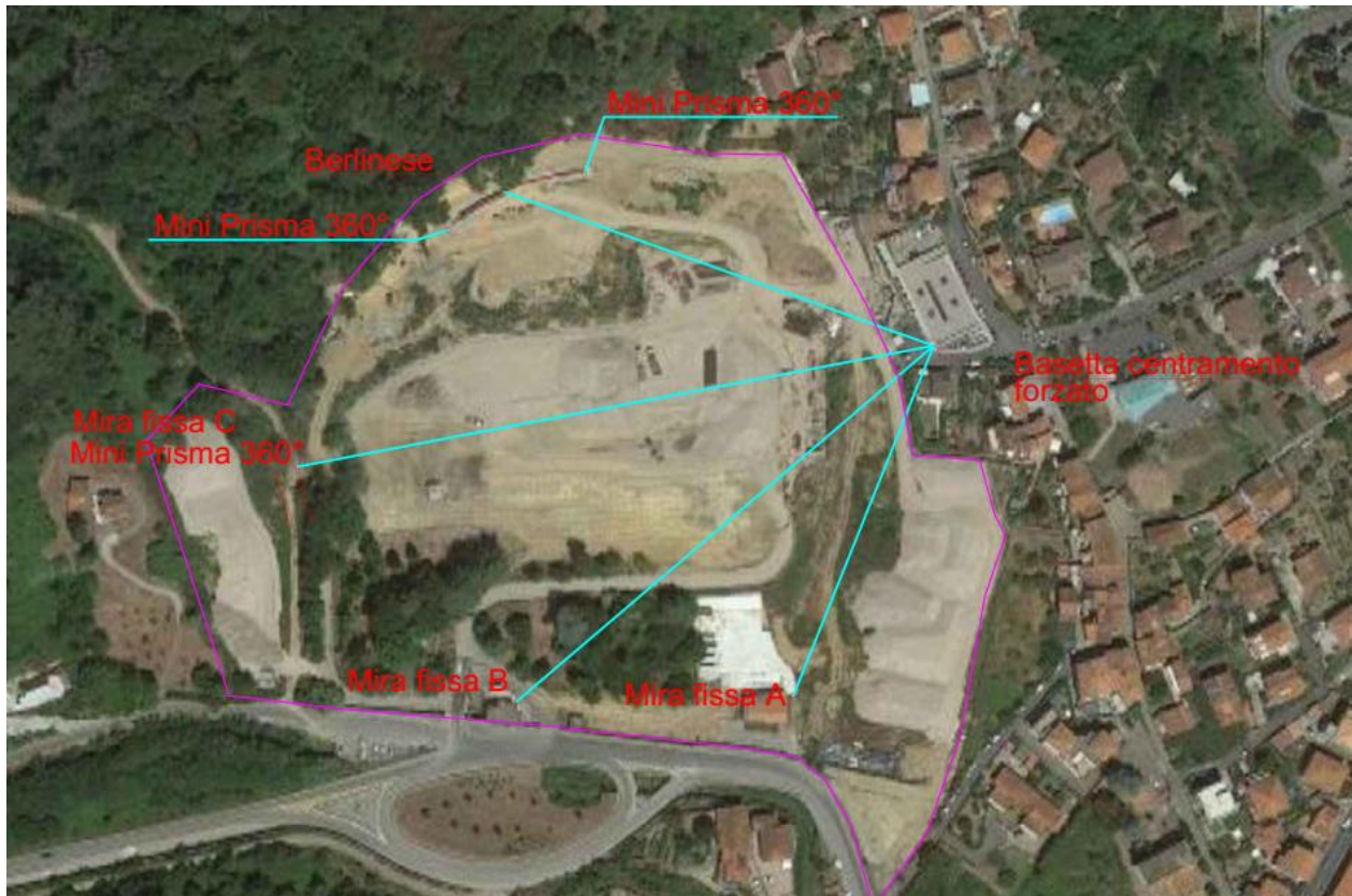
Figura 4.15 Disposizione planimetrica stazione totale e prismi
