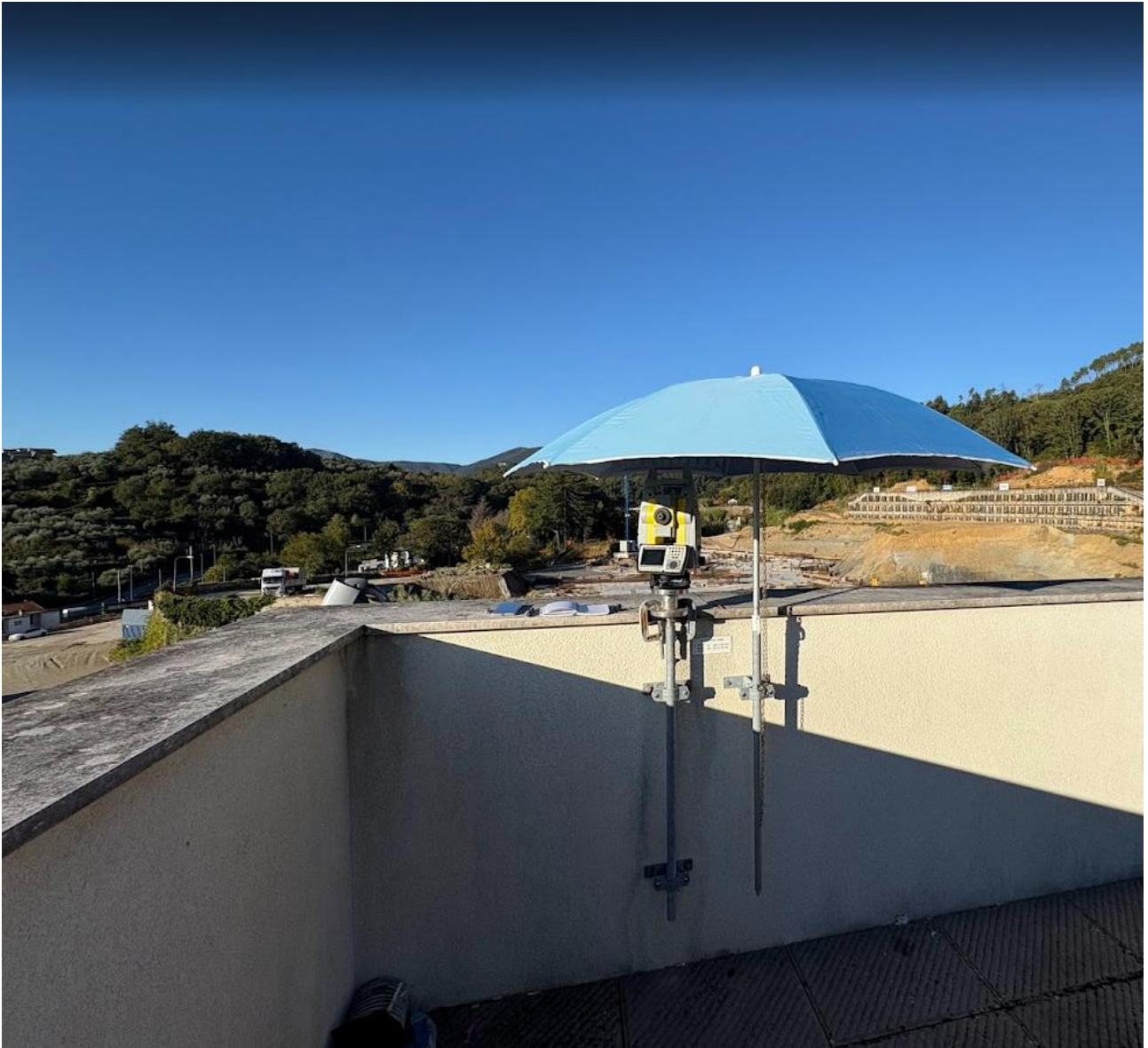
Figura 4.14 Stazione totale di misura situata in cima all'edificio di radioterapia
