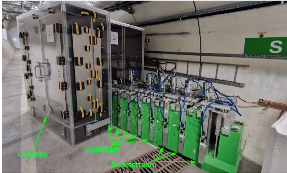
Figura 1.10: Foto del rivelatore, in cui vengono messi in evidenza le due regioni US e DS del sistema di identificazione dei muoni e la cold box del bersaglio
