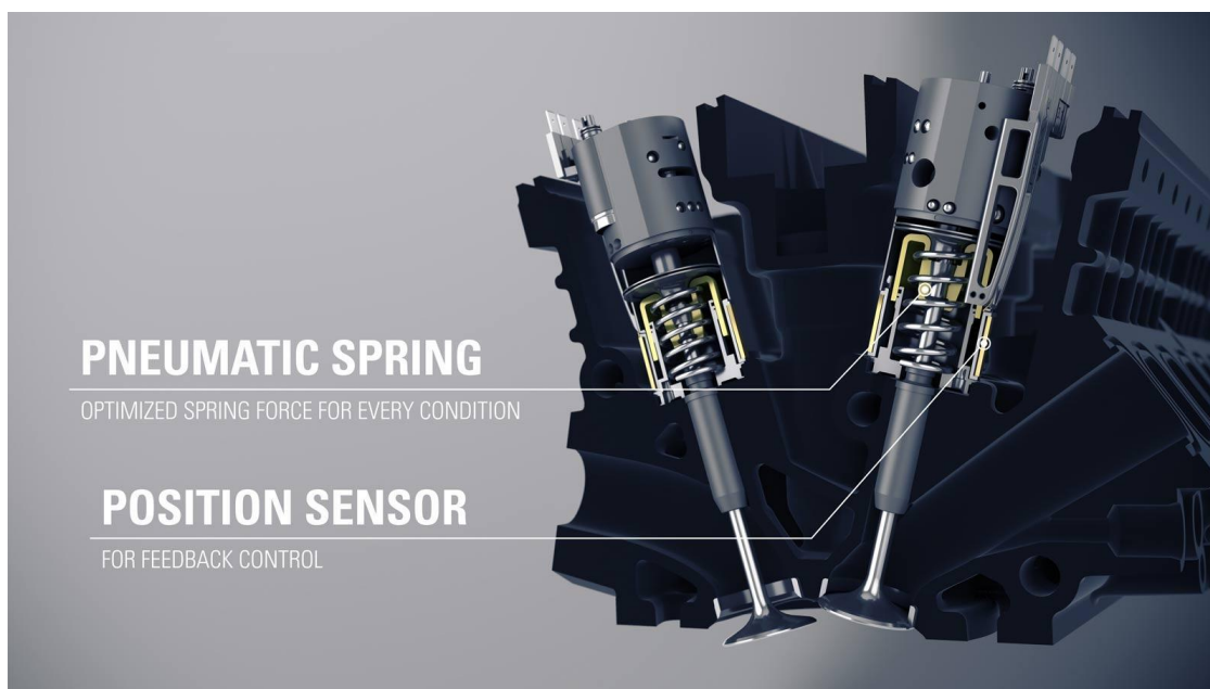
Figura 34: Spaccato del sistema FreeValve, è possibile notare la presenza della molla di richiamo.[13]
