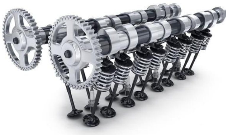
Figura 6: Sistema di distribuzione bialbero DOHC (Double Overhead Camshaft) con doppio albero a camme in testa dedicato al comando delle valvole di aspirazione e scarico. [2]
