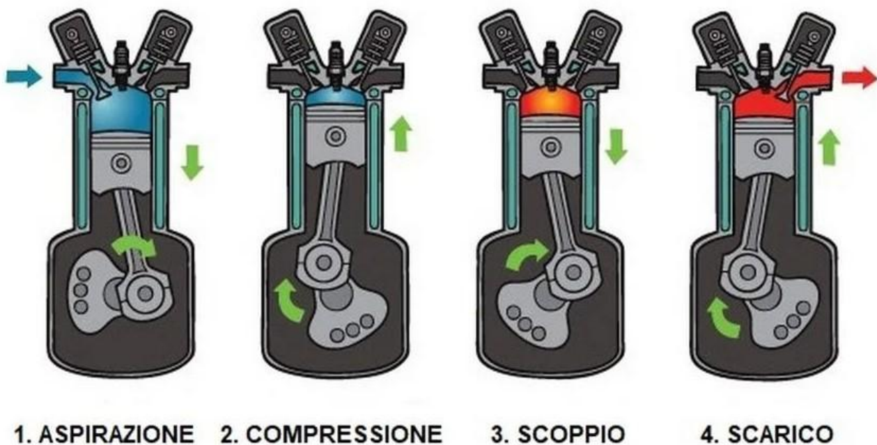
Figura 1: Rappresentazione grafica delle fasi del ciclo Otto. [1]
