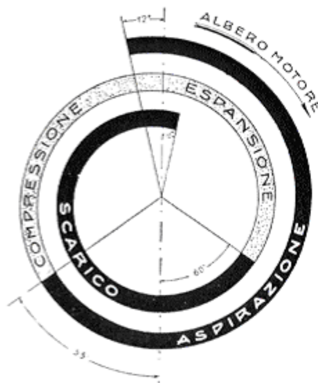
Figura 7: Diagramma polare della distribuzione in un motore a quattro tempi. Nel diagramma sono rappresentati gli istanti di apertura e chiusura delle valvole rispetto alla rotazione dell'albero motore. [1]
