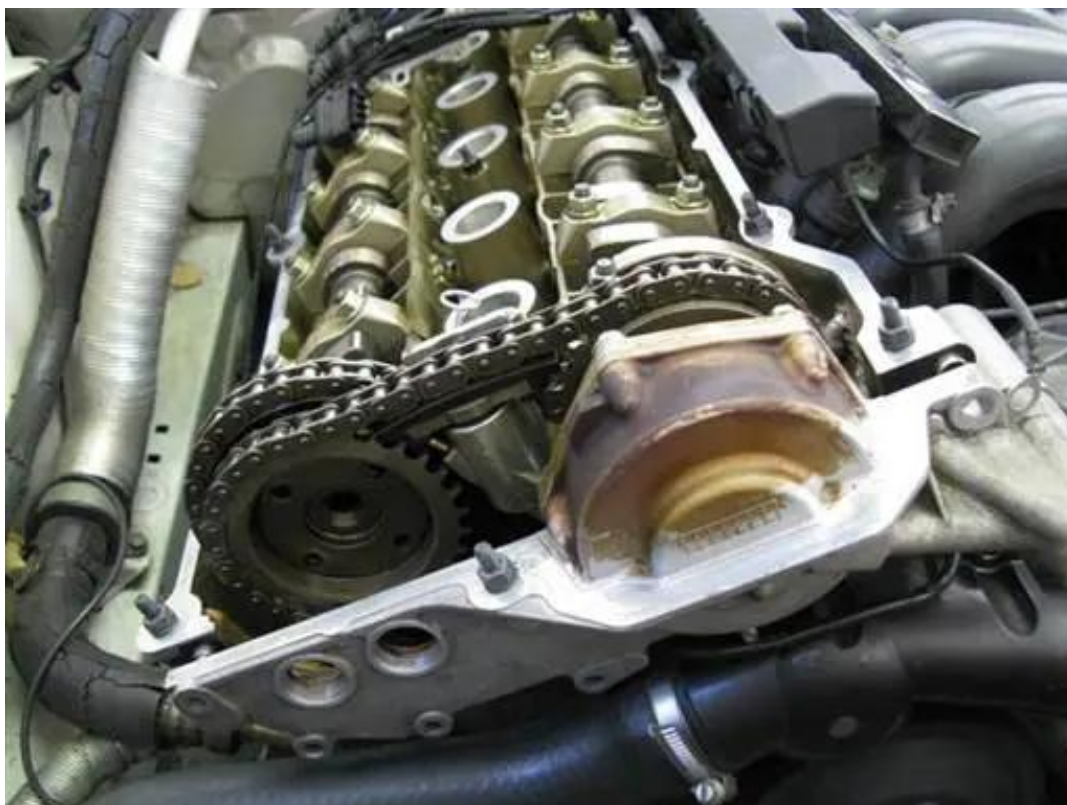
Figura 17: Nell'asse a camme di destra (aspirazione) è possibile notare il VANOS singolo. [8]
