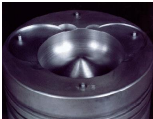
Fig. 6.4 Incavatura cielo pistone motore [28]
