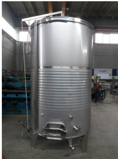
Figura 23 serbatoio a tetto galleggiante
