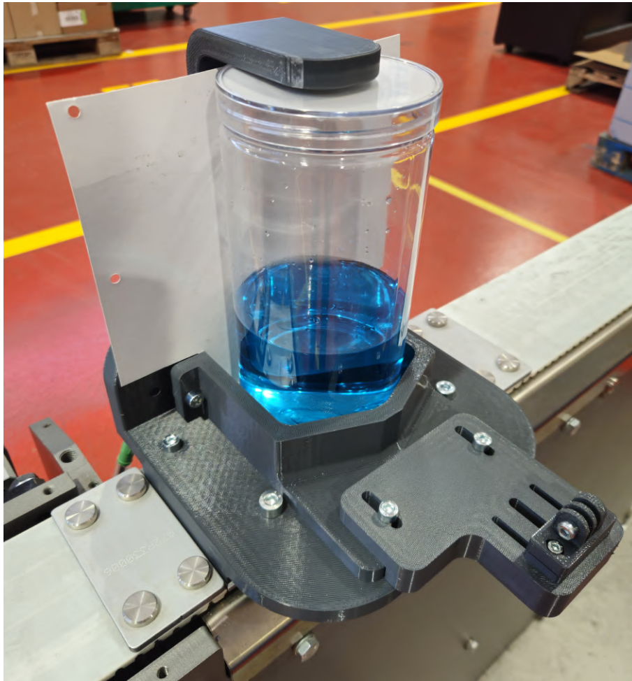
Figura 5.3: Banco prova allestito per i test: contenitore bloccato, tramite i supporti, sul carrello dell'asse lineare e configurazione per acquisizione video. La parete bianca sullo sfondo aumenta il contrasto del pelo libero.
