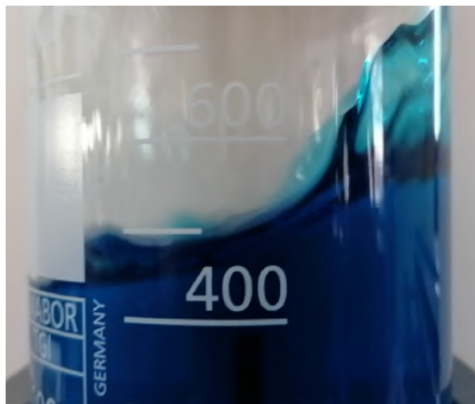
Figura 1.1: Oscillazione di un liquido all'interno di un contenitore cilindrico movimentato dall'esterno.
