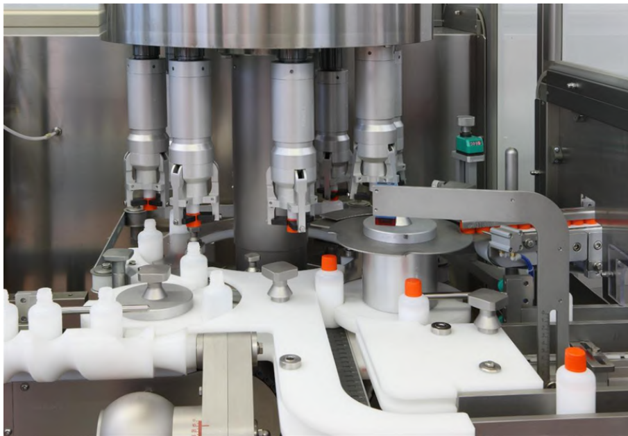
(b) Moto rotatorio e stazione di tappatura.
