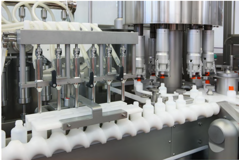
(a) Moto rettilineo e stazione di riempimento.
