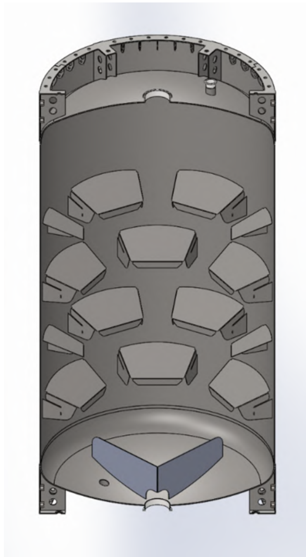
Figura 1.3: Sezione del serbatoio del razzo spaziale Spica con baffles anti-sloshing.
