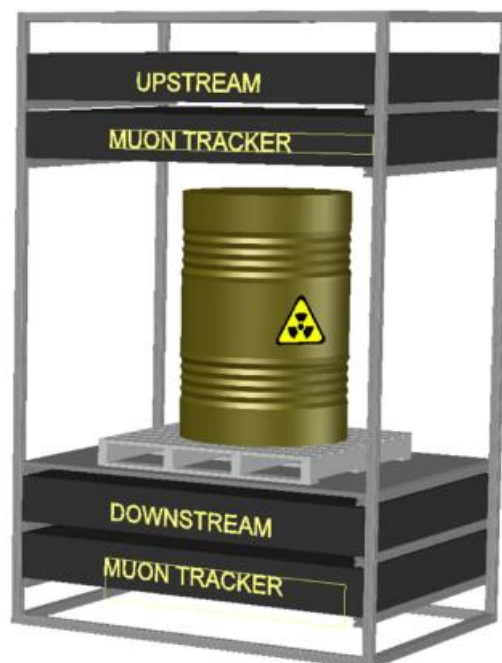
Figura 3.1: Esempio di tomografia a muoni SM di un rifiuto nucleare, si noti la presenza della coppia di rivelatori posta a tracciare il flusso muonico in ingresso ed in uscita [11].
