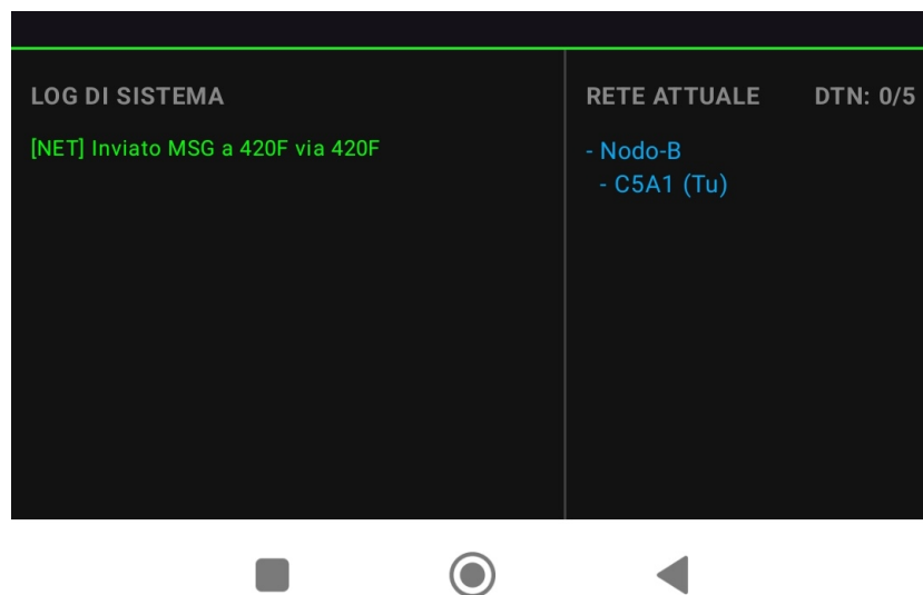
Figura 4.2: Output della console di debug che conferma il corretto instradamento deterministico di un messaggio.
