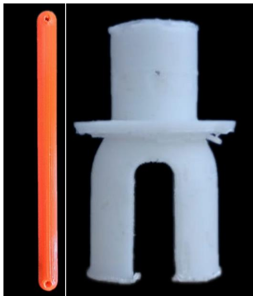
Figura 56: a) Assale posteriore con wall completo; b) Mozzo secondo l'orientamento di stampa ottimale.
