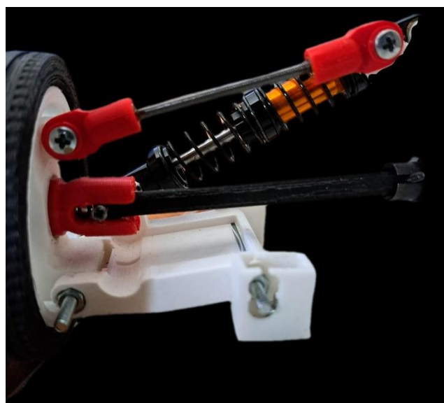
Figura 58: Sospensione posteriore ottimizzata.
