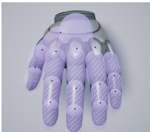
Figura 6.9: Physics Asset della mano. In viola i corpi di collisione dedicati per ciascun dito e il palmo
