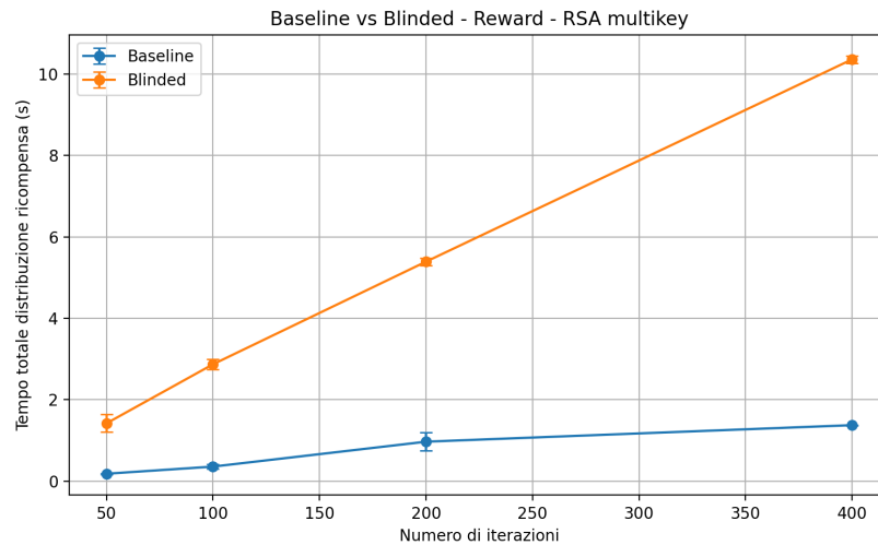
Figura 4.2: Confronto tra comunicazione baseline e comunicazione blindata nella fase di distribuzione della ricompensa per il sistema multi-key basato su RSA
