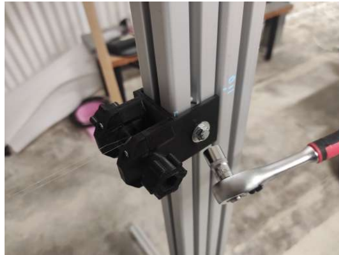
Figura A.1: Allentare i bulloni e, per agevolare lo scorrimento, applicare pressione su entrambi i bulloni.
