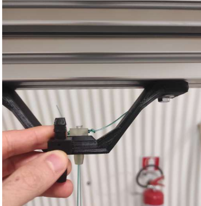
Figura A.2: Evitare di tensionare troppo il tubo in silicone onde evitare la rottura del nozzle.
