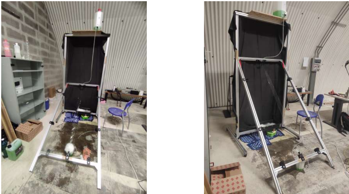
Figura 5.1: Telaio secondario estratto, con formazione di film inclinato
