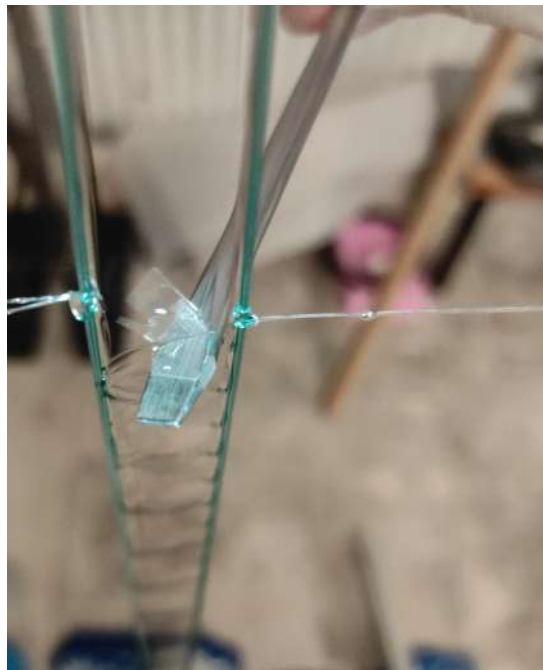
Figura 6.3: Interferenza nel film causata da un corpo estraneo.
