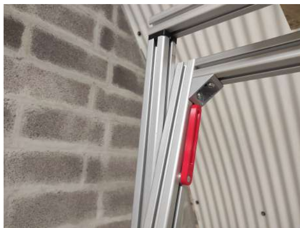
Figura 3.3: Leva di serraggio con bullone passante.
