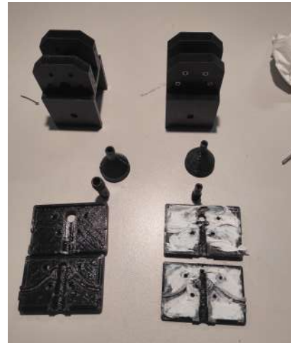
Figura 3.11: Due prototipi, impermeabilizzati con colla riempitiva e nastro al teflon.
