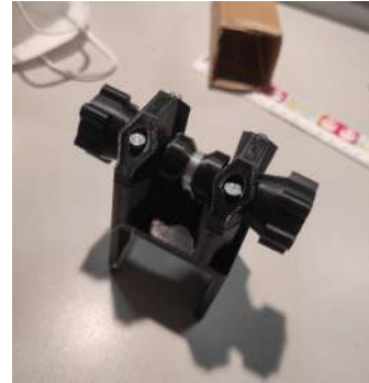
Figura 3.5: Tensionatore stampato in pla e assemblato.
