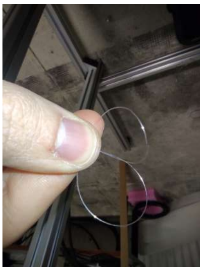
Figura 3.17: A sinistra, realizzazione dell'asola, a destra, inserimento filo guida nell'asola.
