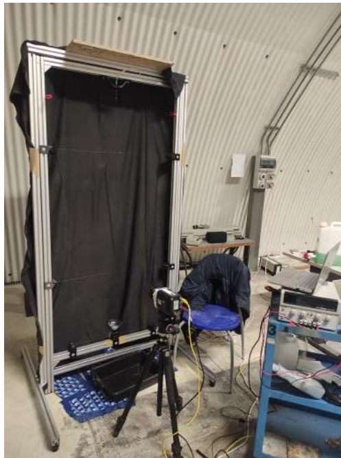
Figura 6.1: Immagine del telaio configurato per le riprese.
