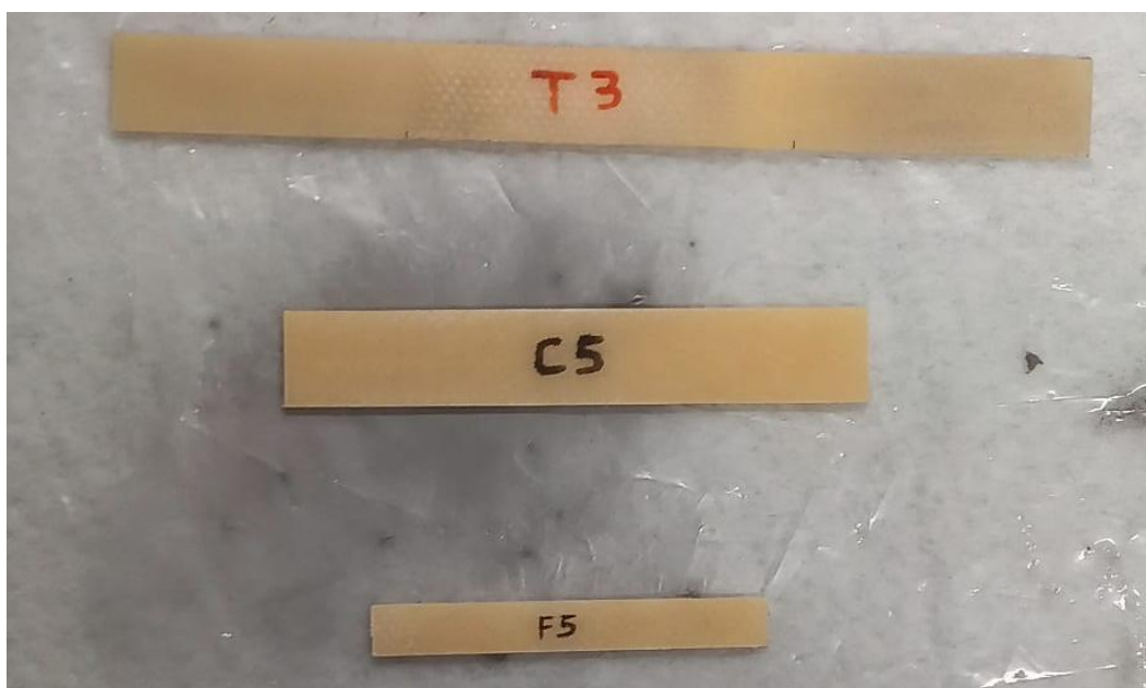
Figura 44: Provini per prove di trazione, compressione e flessione.
