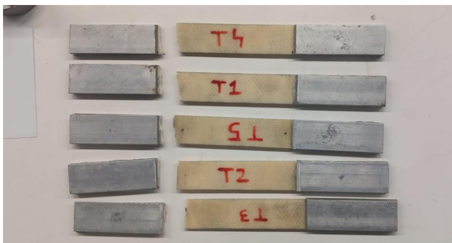
Figura 48: Provini per prova trazione con tab in alluminio, dopo la rottura.
