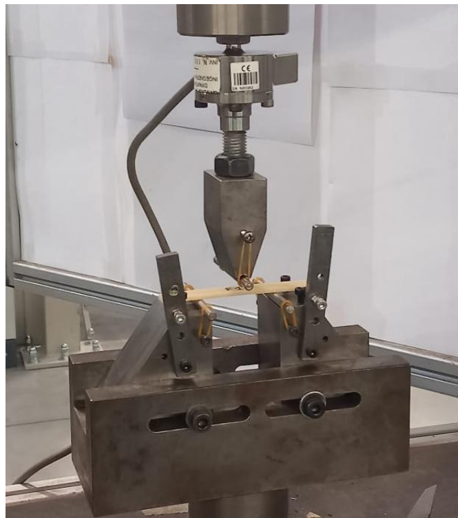
Figura 56: Preparazione prova di flessione a tre punti.
