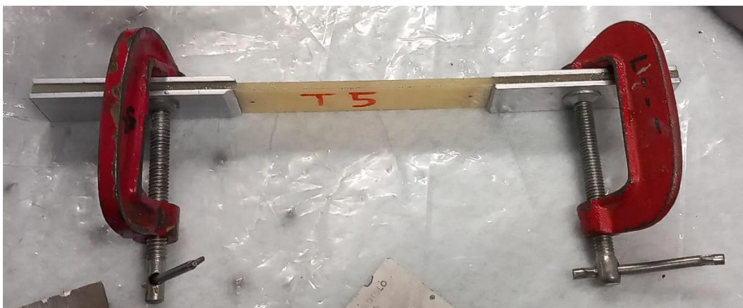
Figura 45: Fase di incollaggio tab.
