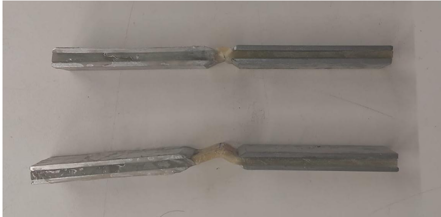
Figura 53: Differenza tra un provino ritenuto non accettabile (provino in basso) ed uno accettabile (provino in alto)
