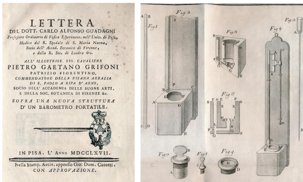
Figura 2.3: (a) Frontespizio della Lettera del dott. Carlo Alfonso Guadagni all' Illustrissimo Signor Cavaliere Pietro Gaetano Grifoni Sopra una nuova struttura d'un Barometro Portatile del 1767; (b) Schema del barometro trasportabile. Tratto dalla Misc. 515.1 della Biblioteca Universitaria di Pisa.
