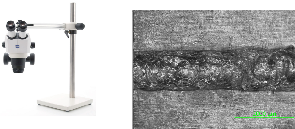
Figura 3.3: Stereomicroscopio e cordone visto attraverso lo stereomicroscopio. Immagine estratta da: [7]
