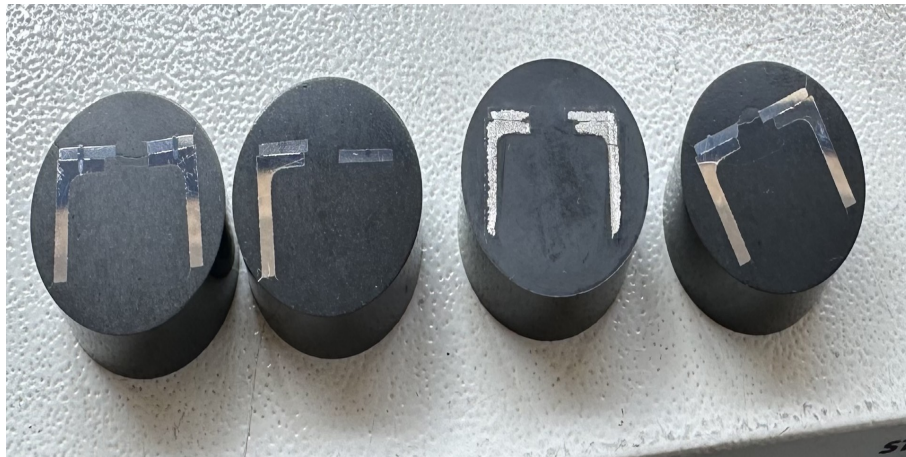
Figura 3.5: Provini in fase avanzata di lucidazione e un provino appena inglobato, non lucidato.
