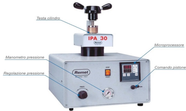
Figura 3.4: Inglobatrice IPA 30 Remet. Immagine estratta da: [8]
