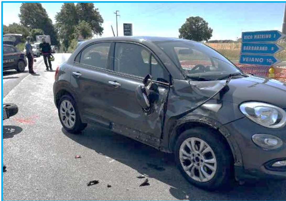
Figura 20: dettaglio dei danneggiamenti alla Fiat 500X.
