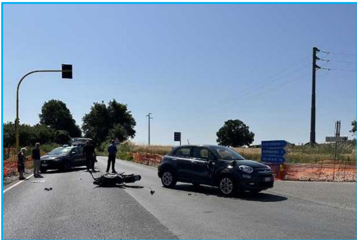
Figura 18: dettaglio dei detriti e delle posizioni di stasi assunte dalla Fiat 500X e dalla Triumph Trident 660 dopo l'urto, nella direzione di marcia di quest'ultima.
