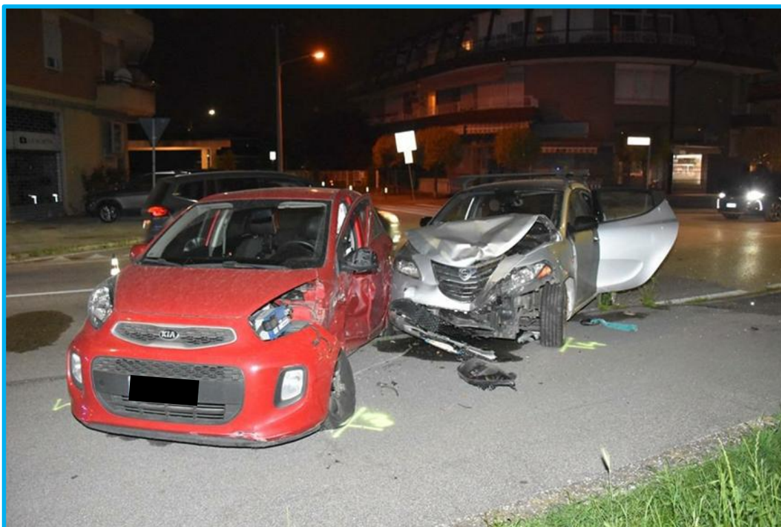
Figura 31: particolare frontale delle posizioni di stasi e dei danneggiamenti subiti dalle due autovetture.
