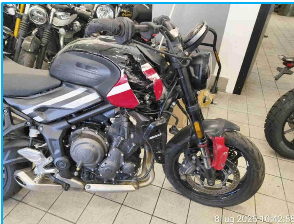
Figura 21: dettaglio dei danneggiamenti alla Triumph Trident 660.
