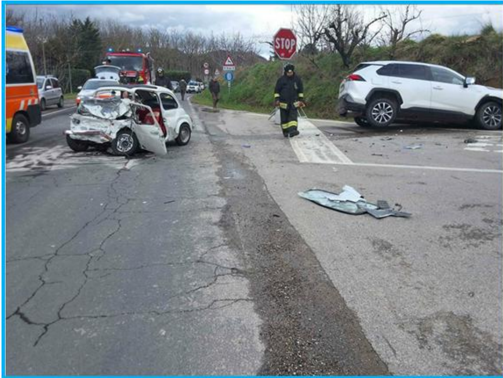
Figura 8: dettaglio delle posizioni di stasi assunte dalla Toyota RAV4 e dalla Fiat 500 dopo l'urto, secondo la direzione di marcia di quest'ultima.
