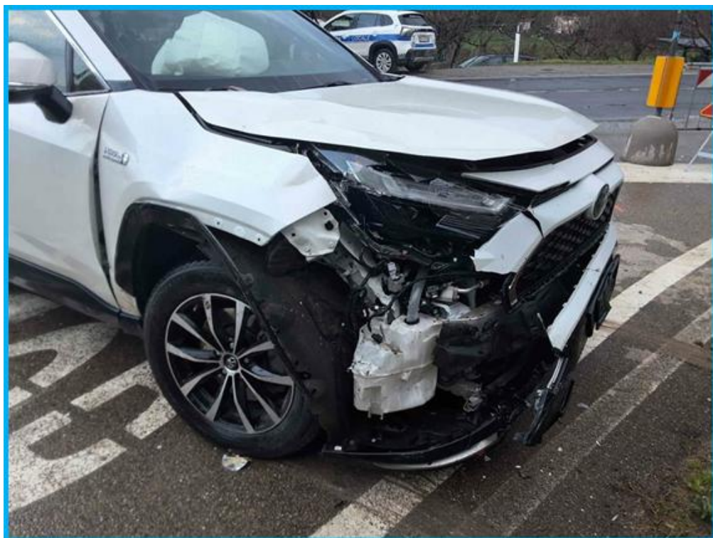
Figura 9: dettaglio dei danneggiamenti riportati dalla Toyota RAV4.
