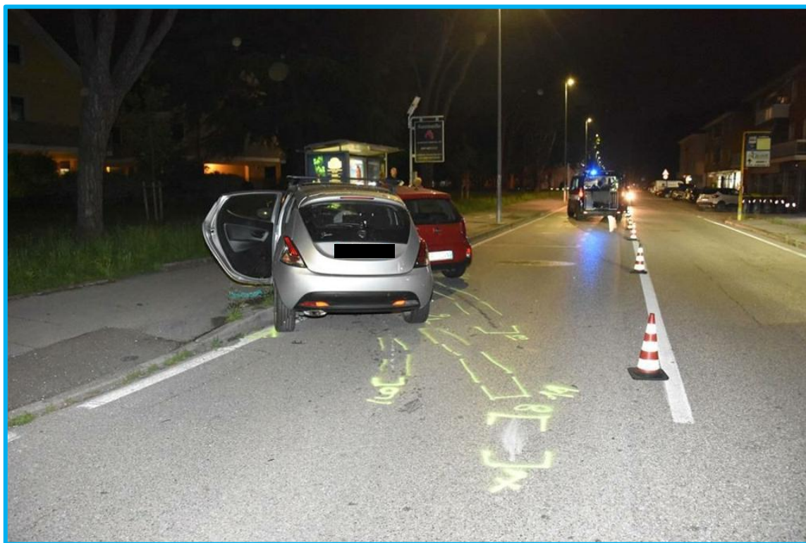
Figura 29: particolare delle posizioni di stasi, delle incisioni e della traccia liquida lasciate sul manto stradale a seguito dell'urto, secondo la direzione di marcia della Lancia Ypsilon.
