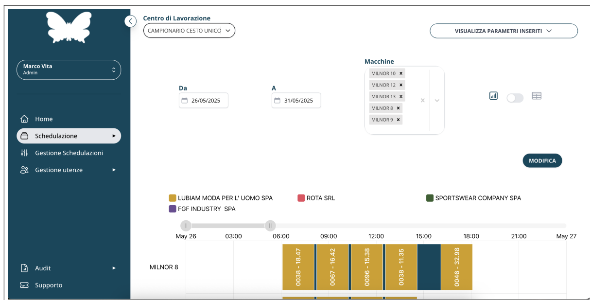
Figura 3.11: Il Gantt permette la visualizzazione delle singole task della schedulazione, portando il mouse in hover su di un blocco del Gantt ne si vedono i dettagli e cliccandoci sopra si apre un modale che fornisce le informazioni in modo dettagliato. Notiamo poi un pulsante "MODIFICA" che abilita la modalità di edit dei valori dei blocchi tramite il modale di cui sopra. Inoltre, è possibile tramite un input Range modificare l'intervallo di tempo del quale visualizzare i task.
