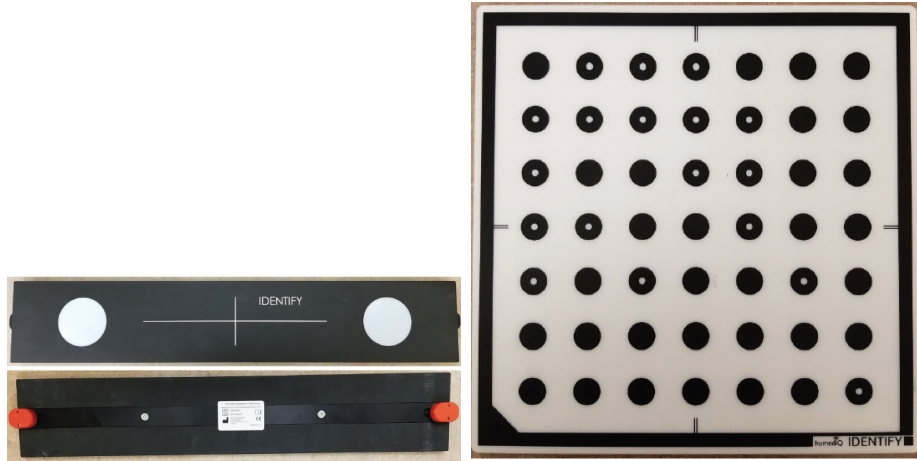
Figura 4.8: A sinistra il dispositivo di calibrazione dell'isocentro per le telecamere di setup e a destra la piastra di calibrazione per l'isocentro delle telecamere per la SGRT. [14]
