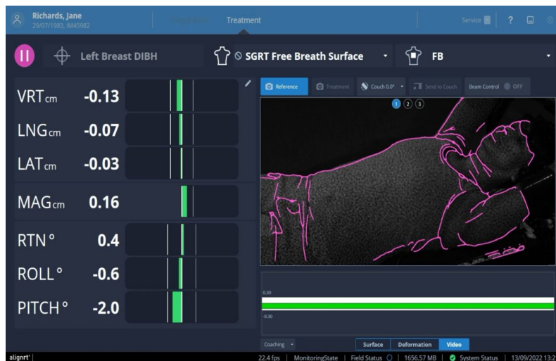
Figura 4.11: Display visualizzato durante l'utilizzo della funzionalità Postural Video™, sulla sinistra i valori della differenza tra le superfici sono rappresentati come sbarre che se si trovano nella finestra di tolleranza sono verdi altrimenti arancioni e sulla destra il video del paziente con sovrapposto il contorno della superficie di riferimento in viola. Con i numeri in alto sul video da 1 a 3 l'operatore può scegliere con quale telecamera vedere il paziente permettendo un monitoraggio completo di tutta la superficie. [38]
