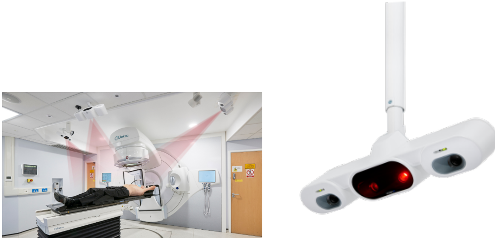
Figura 4.10: A destra sinistra dei componenti del sistema AlignRT nella stanza di trattamento e a destra una delle unità del sistema. [38]
