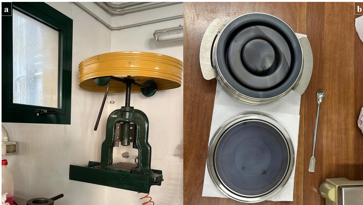
Figura 8.7: a) polverizzatore con pressa per distruggere i campioni di roccia; b) dischi in agata entro cui deve essere inserito il campione di roccia/suolo per essere polverizzato.
