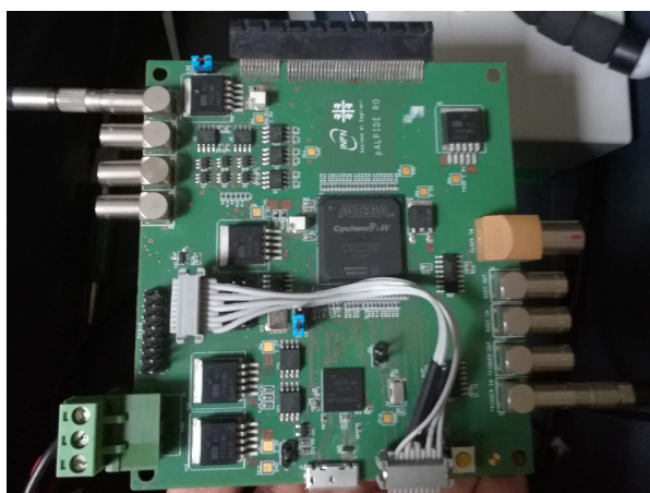
Figura 3.5: Fotografia di una delle due DAQ boards utilizzate. Esse contengono una FPGA con un software proprietario che viene caricato da PC sulle schede per la programmazione dei MAPS.
