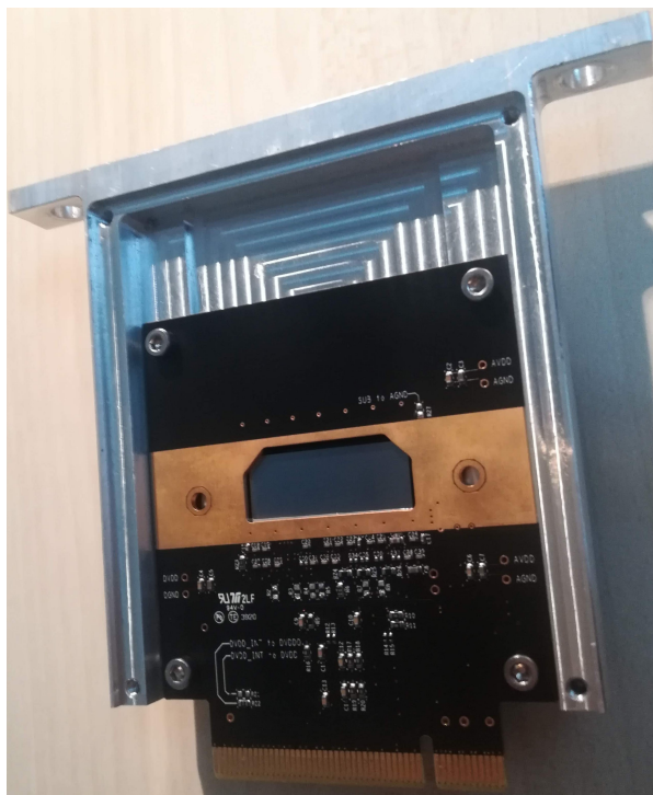
Figura 3.4: Fotografia del retro del sensore montato sulla carrier board, alloggiata nel suo supporto metallico mediante il quale è fissata alla struttura del telescopio.
