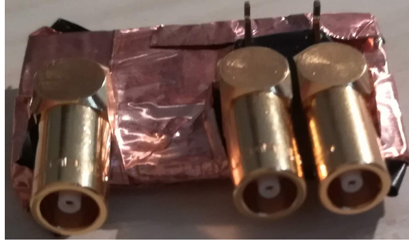
Figura 3.3: Fotografia di una delle due schede collegate alle due coppie di scintillatori-SiPM. A sinistra l'ingresso LEMO per la tensione di polarizzazione, a destra i connettori LEMO per i due segnali di uscita.
