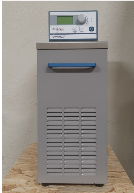
Figura 4.2: Bagno termostatico utilizzato per la calibrazione.
