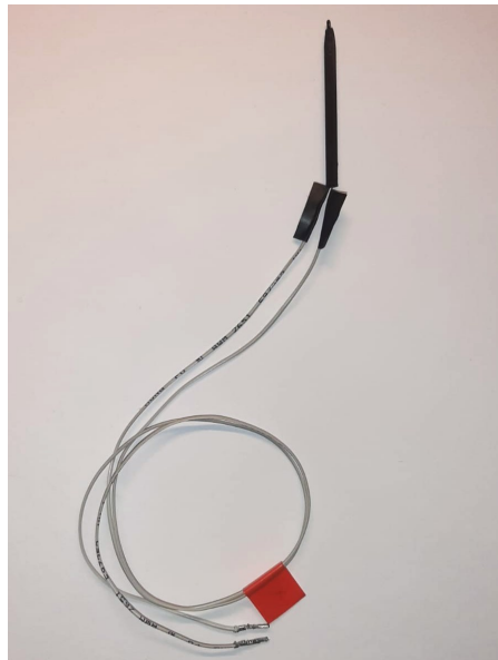
Figura 3.12: Termistore alloggiato nel componente di connessione.
