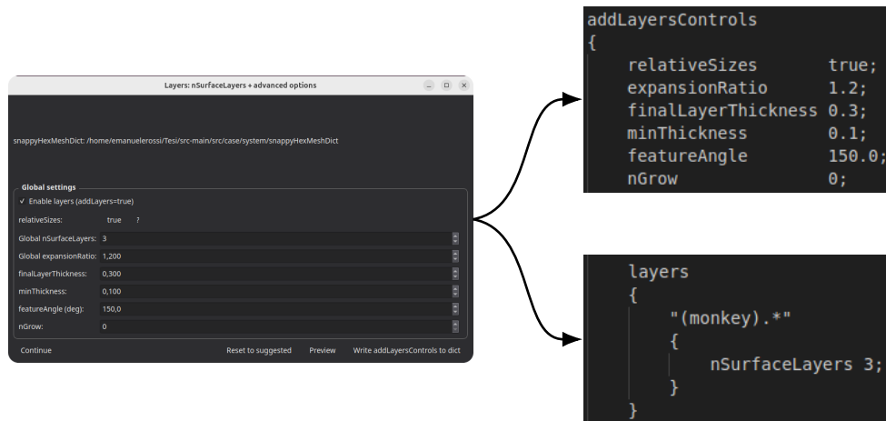
Figura 2.7: GUI per addLayersControls : impostazione di relativeSizes , numero di layers, expansionRatio , finalLayerThickness e parametri globali per l'estrusione dei layers.
