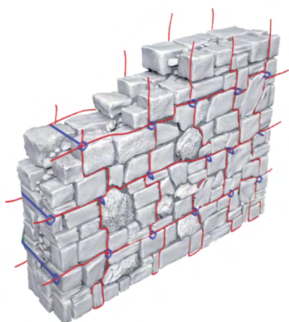
Figura 5.1: Sistema di ristilatura armata dei giunti su entrambe i prospetti
