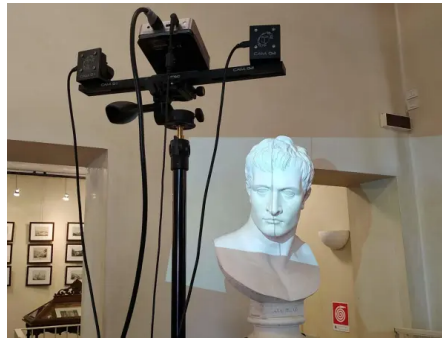
Figura 1.2: Digitalizzazione di un'opera artistica tramite rilievo con scanner 3D Fonte: 3D ArcheoLab
