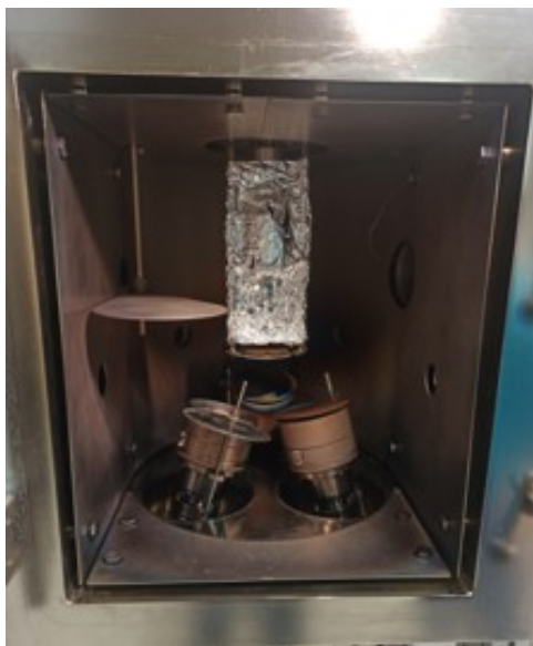
(a) Interno della camera a vuoto. In basso, i 3 catodi. In alto al centro, il supporto per il substrato del campione da produrre.
