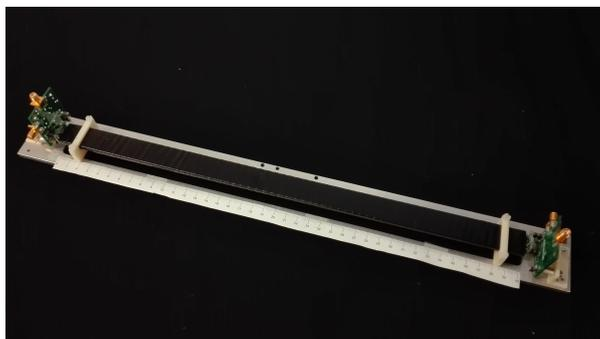
Figura 2.10: Barra di scintillatore plastico del TOF-Wall.
