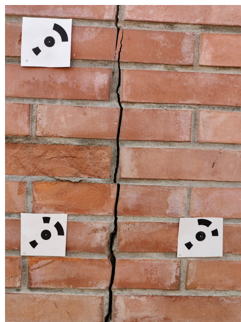
Figura 2.3: Foto con 3 markers attorno alla crepa
