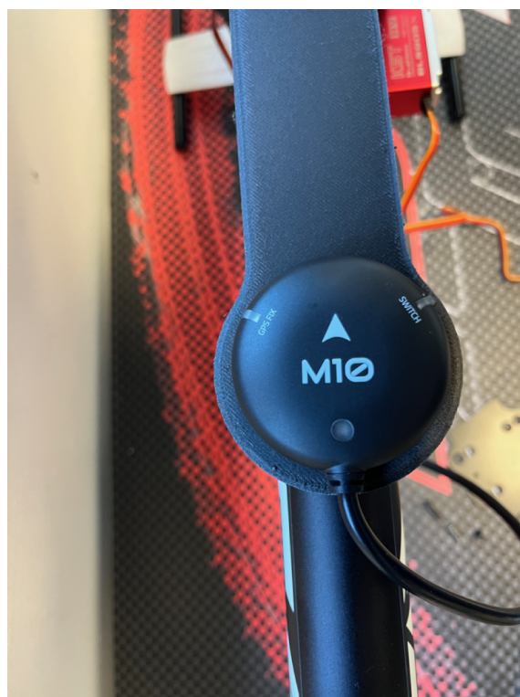
Figura 4.8: GPS fissato sulla piastrina.
