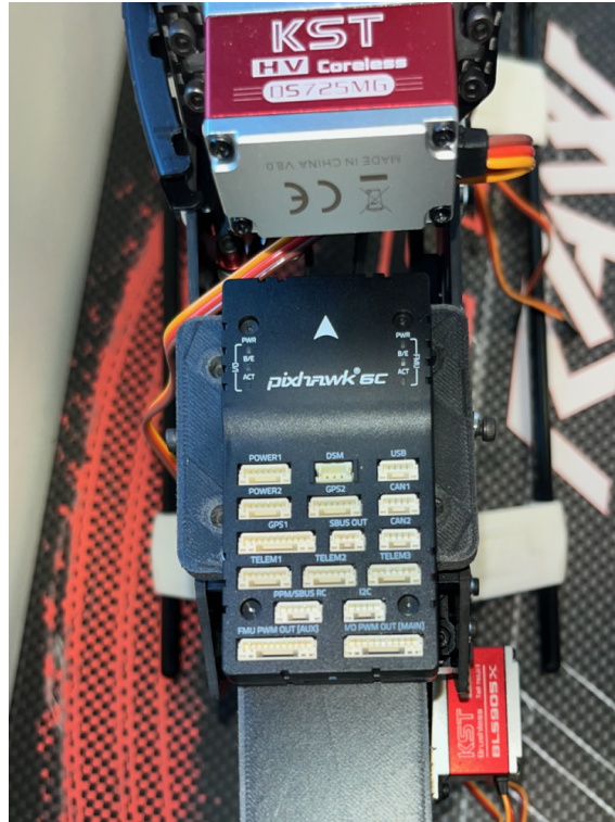
Figura 4.3: Pixhawk 6C fissato al telaio con supporti antivibrazione.
