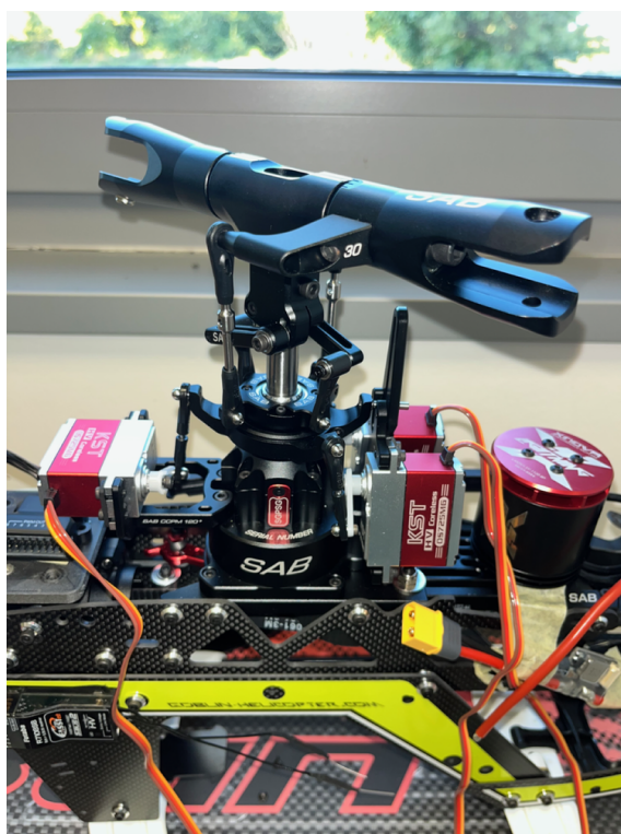
Figura 4.10: Servocomandi collegati al piattello oscillante.
