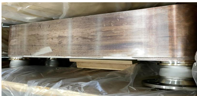
Prototipo di scambiatore realizzato da GE Research chiamato UPHEAT – Ultra performance heat exchanger enabled by Additive technology: lo scambiatore è in grado di sopportare temperature fino a 900° C, livello che supera di circa 200° C l'attuale limite degli scambiatori in commercio. Una simile macchina termica potrebbe secondo i ricercatori di GE trovare applicazione nel settore dell'energia, per abilitare una produzione di energia più pulita ed efficiente [6]
