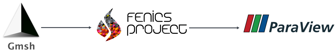
Figura 3.1: Workflow di simulazione numerica: Gmsh per la generazione della mesh, FEniCSx per la risoluzione delle equazioni e ParaView per il post-processing.
