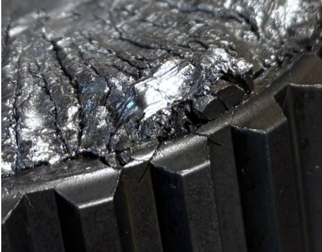
Figura 3.2: Cricche orientate a \pm 45^\circ sul troncone scanalato
