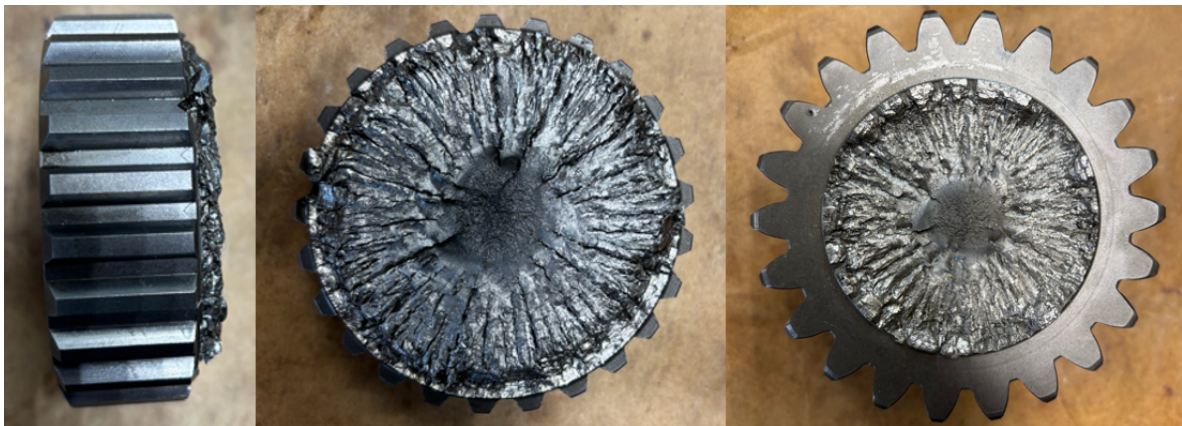
Figura 3.1: Vista laterale troncone scanalato / Superficie di frattura parte scanalata / Superficie di frattura parte dentata
