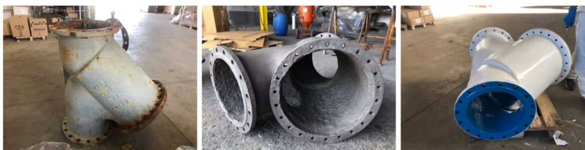
Figura 17 - Esempio di trattamento anticorrosivo su raccordo metallico
