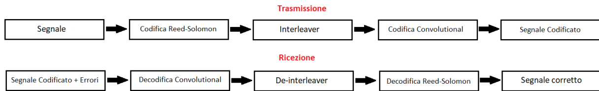
Figura 42 – Schematizzazione del funzionamento del processo di codifica e decodifica di un segnale mediante utilizzo di una codifica concatenata Reed-Solomon/Convolutional con presenza di un interleaver
