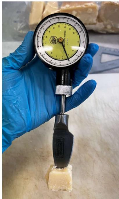
**Figura 21-**Test di penetrazione con Penetrometro.
