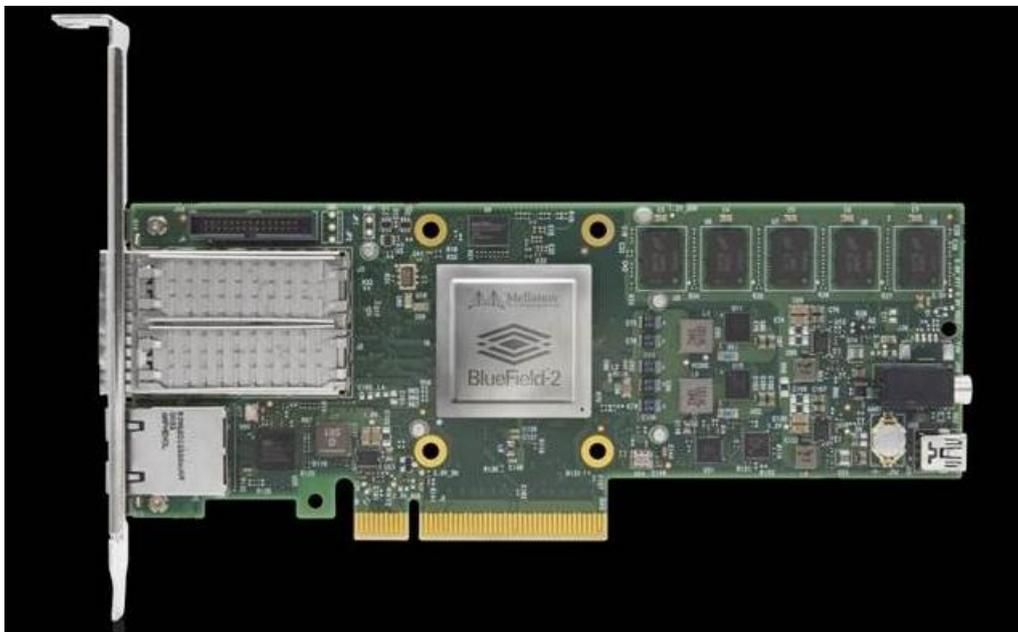
Figura 14: Scheda di rete NVIDIA dotata della DPU BlueField-2 [44]
