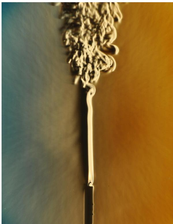
Figura 1.7: Fotografia schlieren del flusso generato dalla rottura di un palloncino. L'immagine rivela le variazioni di densità dell'aria causate dall'onda d'urto e dalla successiva insorgenza della turbolenza. Fonte: *Gary Settles, Own work, CC BY-SA 3.0* (Settles 2012).
