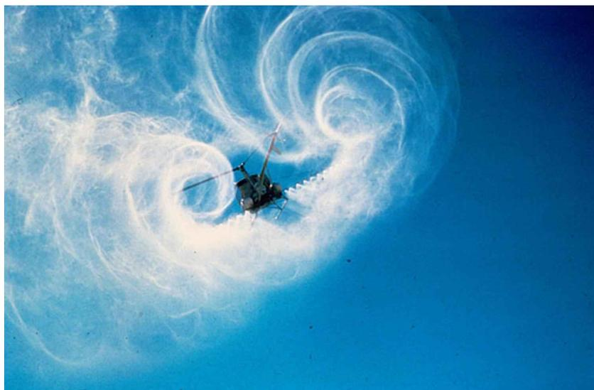
Figura 1.5: Visualizzazione qualitativa della turbolenza indotta dal rotore di un elicottero durante un'operazione di irrorazione. I vortici generati sono chiaramente visibili nella scia, evidenziando le intense strutture turbolente create dall'interazione tra il flusso propulsivo e l'ambiente circostante. Fonte: *Jahons Brad E., U.S. Fish and Wildlife Service, Public Domain* (E. n.d.).
