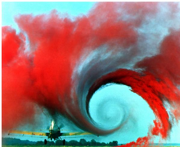
Figura 2.1: Studio NASA-FAA sui vortici di scia: il fumo colorato evidenzia il flusso d'aria attorno all'ala di un aereo agricolo, con il vortice di punta ben visibile. Esperimento condotto a Wallops Island per analizzare le turbolenze post-volo. Fonte: *NASA Langley Research Center, pubblico dominio* (NASA Langley Research Center 1996).
