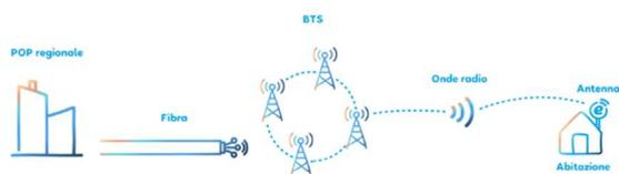
Schema della rete di collegamento tramite fibra ottica e segnali radio di Eolo
