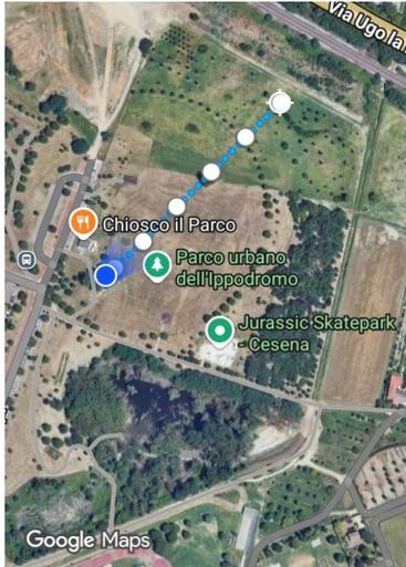
**Figura 5.3:** Posizioni di test da 10m a 250m con ostacoli.
