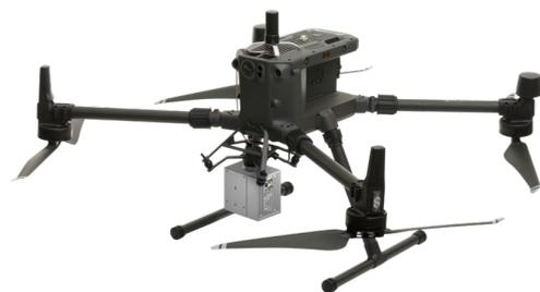
Figura 2.9: DIJI Matrice 300 RTK + TOPODRONE LiDAR AVIA
