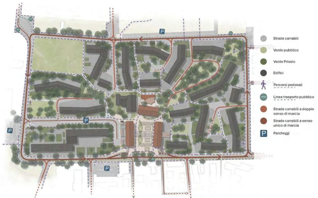
Figura 4 mappatura viabilità di progetto
