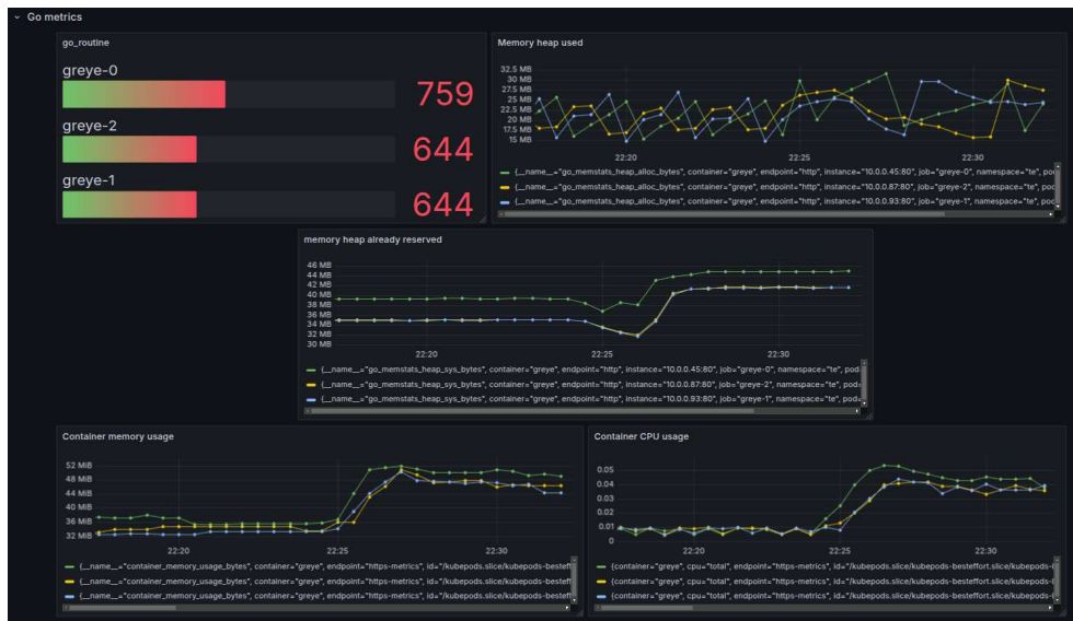
Figura 11.2: Metriche di Greye in fase di test di carico
