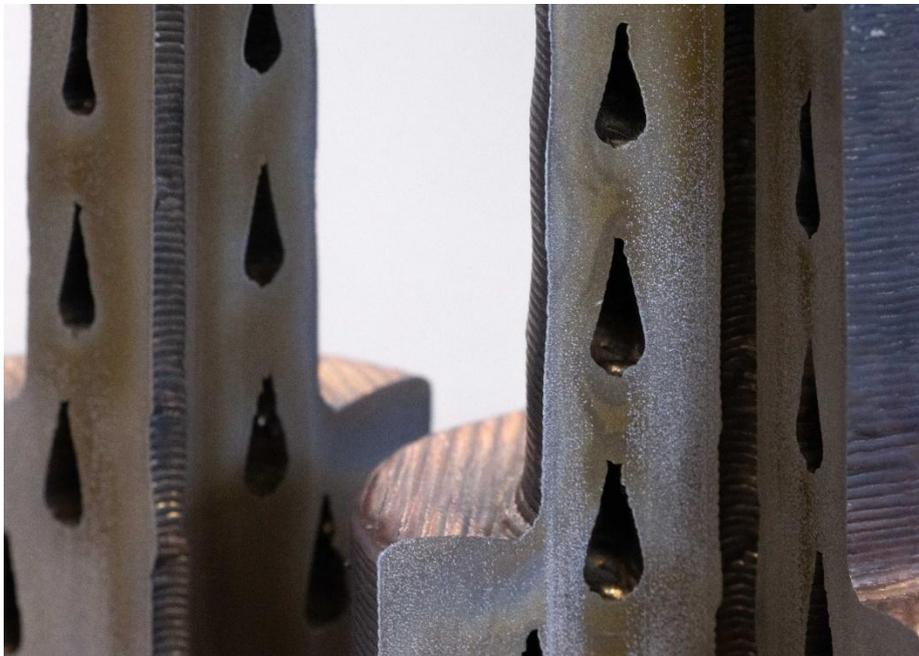
**Figura 14:** *Condotti di raffreddamento realizzati tramite stampa 3D (foto di proprietà di Meltio)*
