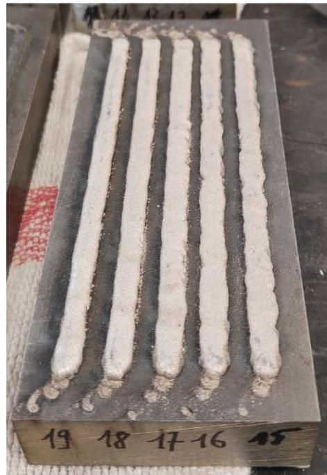
**Figura 22:** *Provini realizzati per testare i parametri di stampa*
