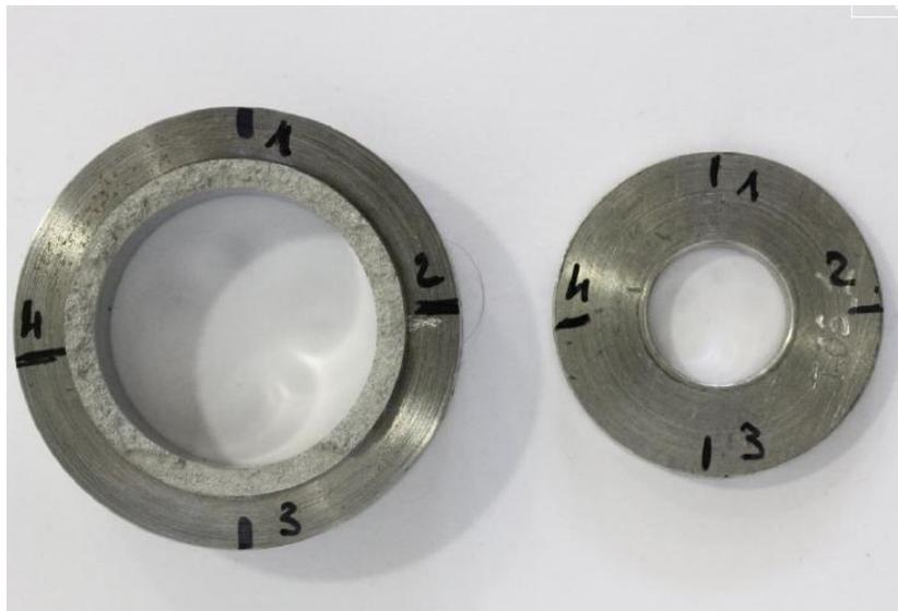
**Figura 30:** Zona di frattura di provini realizzati tramite colata
