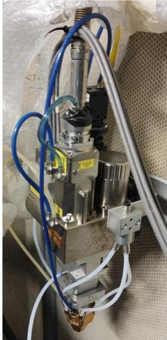
**Figura 19:** *Testa di deposizione*
