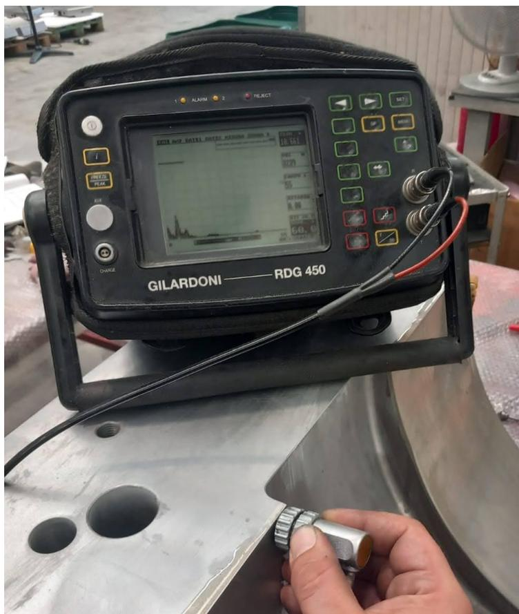
**Figura 13:** *Strumento per l'analisi ad ultrasuoni*
